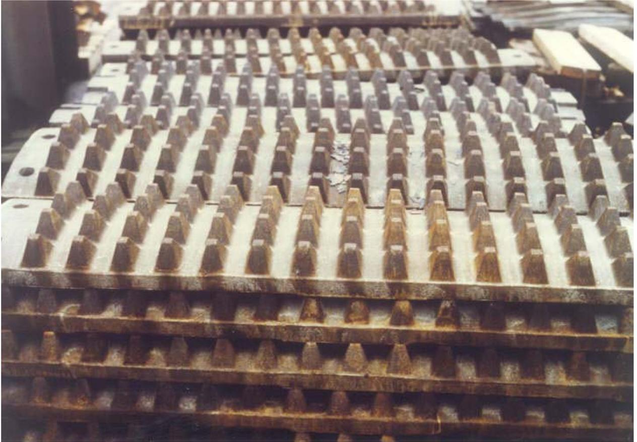
Данная технология позволяет сократить время производственного процесса, избежать разбора роликов до износа внешних зубьев, а также продлить срок службы зубьев дробилки.
