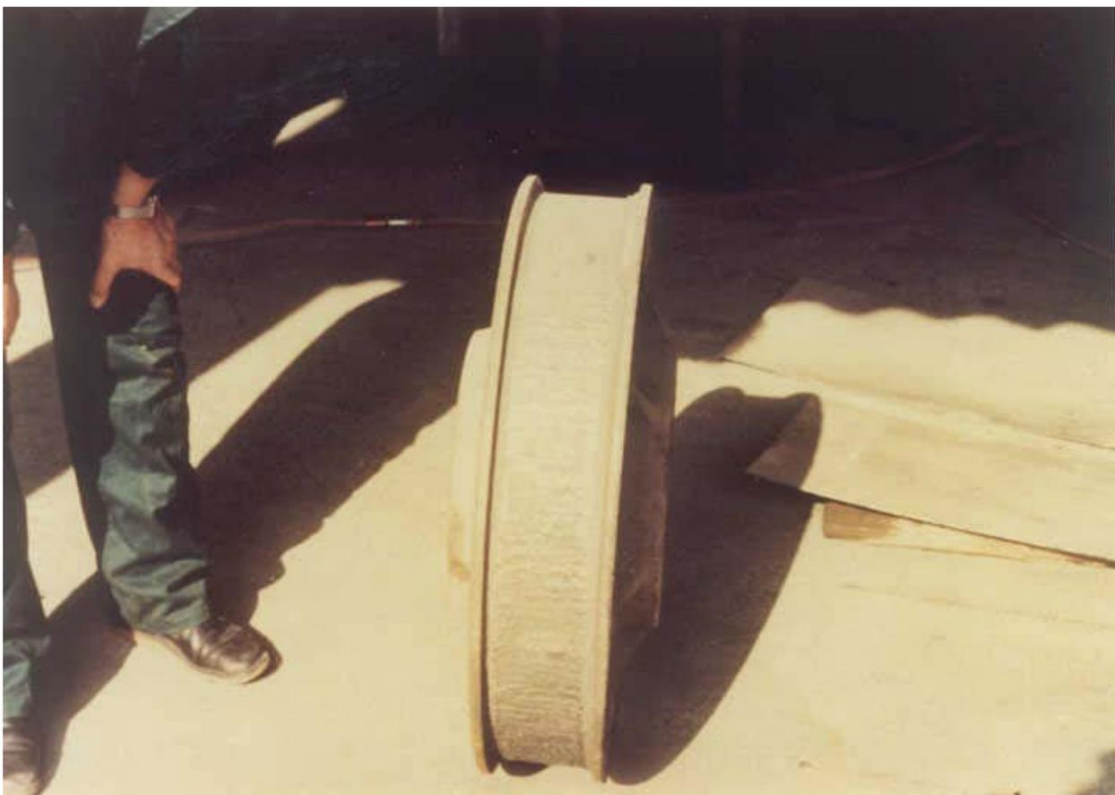
Колесо подвижного крана после наплавки защитного покрытия
