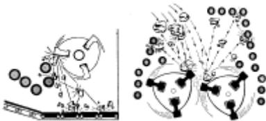
На рисунке слева: одноударная дробилка, оснащенная дробильными плитами и дробильными брусками
