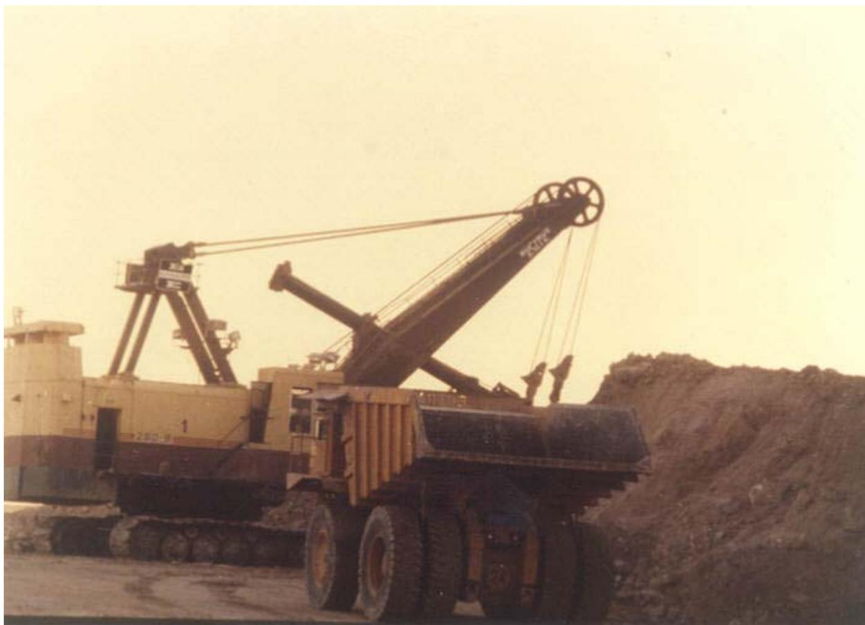
Наплавка защитного покрытия на нижнюю панель кузова производится электродом Lastek 27 или электродом Lastek 2400. В случае значительного износа панели, удалите изношенные детали электродом Lastek 1000 или электродом Lastek 1900, и восстановите несущую панель кузова электродом Lastek 20.
