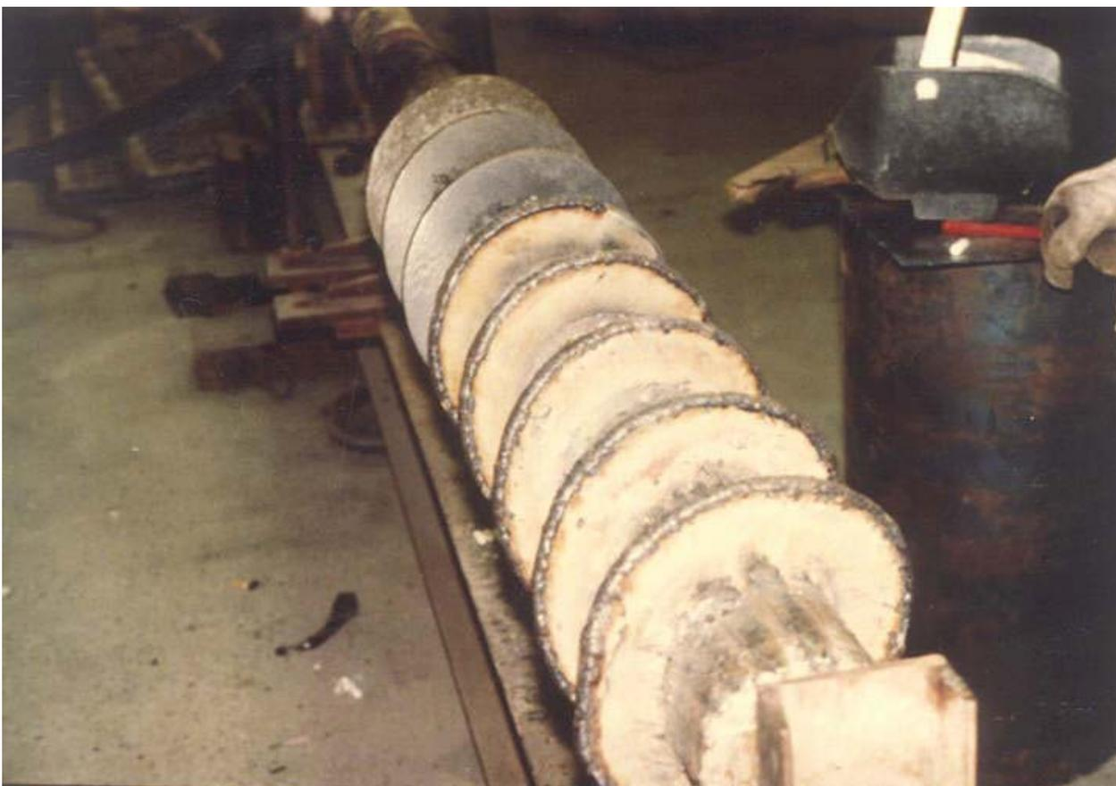
На фотоснимке сверху изображен шнек перед его обработкой до необходимых размеров.
